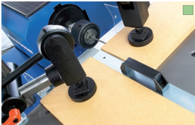
Steckbarer Rahmenanschlag mit 2 Stück Handexzenterpanner
