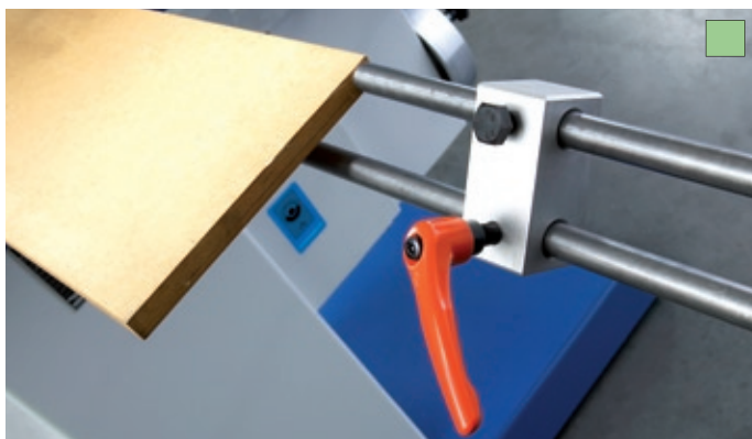
Werkstückanschlag bis 1500 mm lang, stufenlos einstellbar
