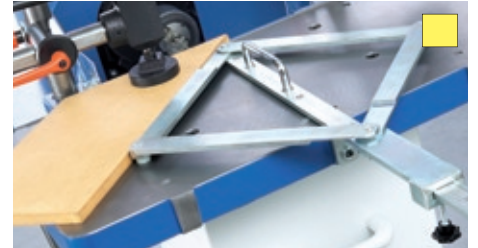
Doppelwinkelverstellanschlag, stufenlos einstellbar 22,5 - 75°
