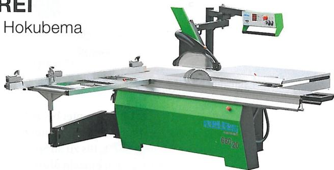
**Formatkreissäge 680-20 mit freischwebendem Bedienpanel**
