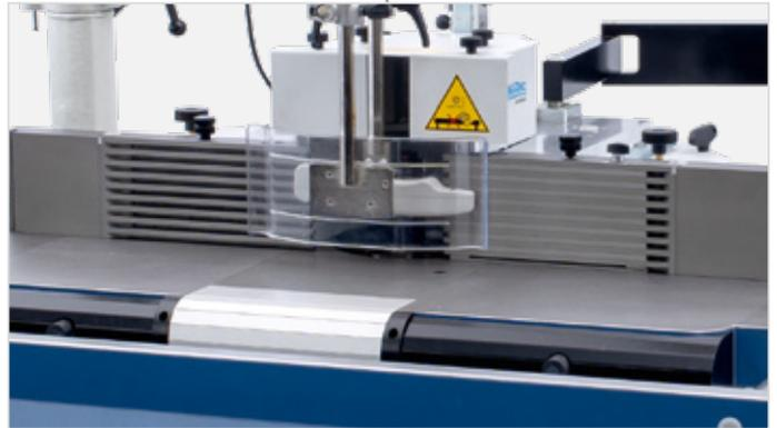
**OPTION:****COMFORT-WEGSCHWENKVORRICHTUNG FÜR FRÄSANSCHLÄGE**
